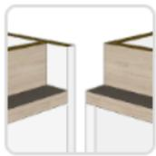
Construcción del tirador travesaño en L
